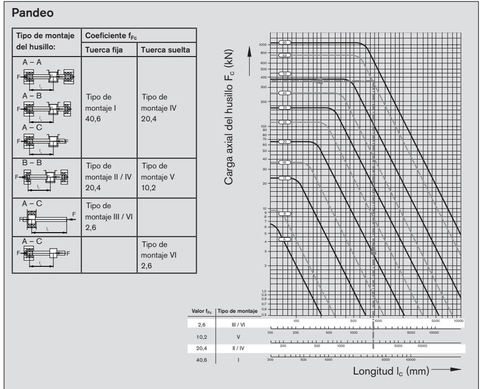
La longitud y el diámetro de husillo, así como el tipo de montaje se tienen en cuenta a la hora de calcular el pandeo de Euler. Así se obtiene la carga de husillo axial admisible (véase el diagrama superior). En la práctica, los cálculos se realizan con las fórmulas que aparecen en el cuadro de la derecha.
