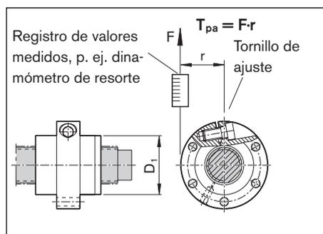
$T_{pa}$  = par de giro en vacío, medido actualmente.
