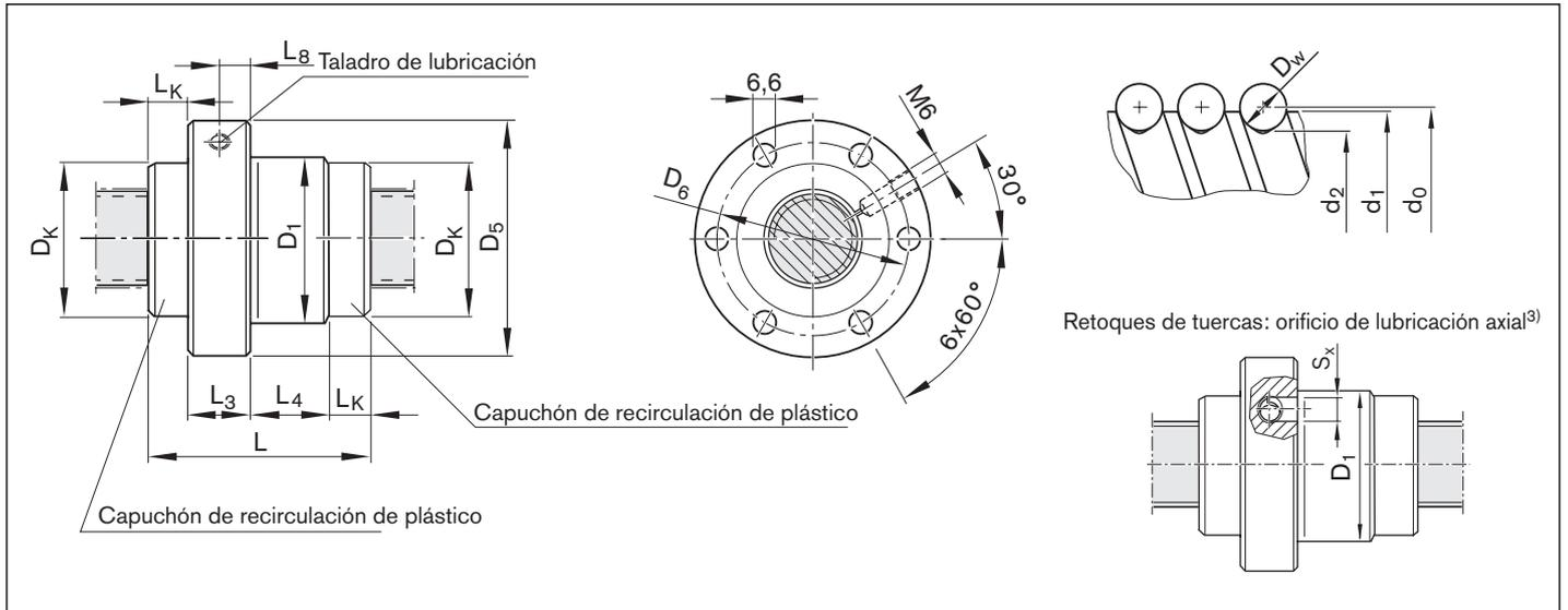
3) El orificio de lubricación axial  $S_x$  está situado siempre en el círculo graduado  $D_6$  de la unidad de tuerca.
