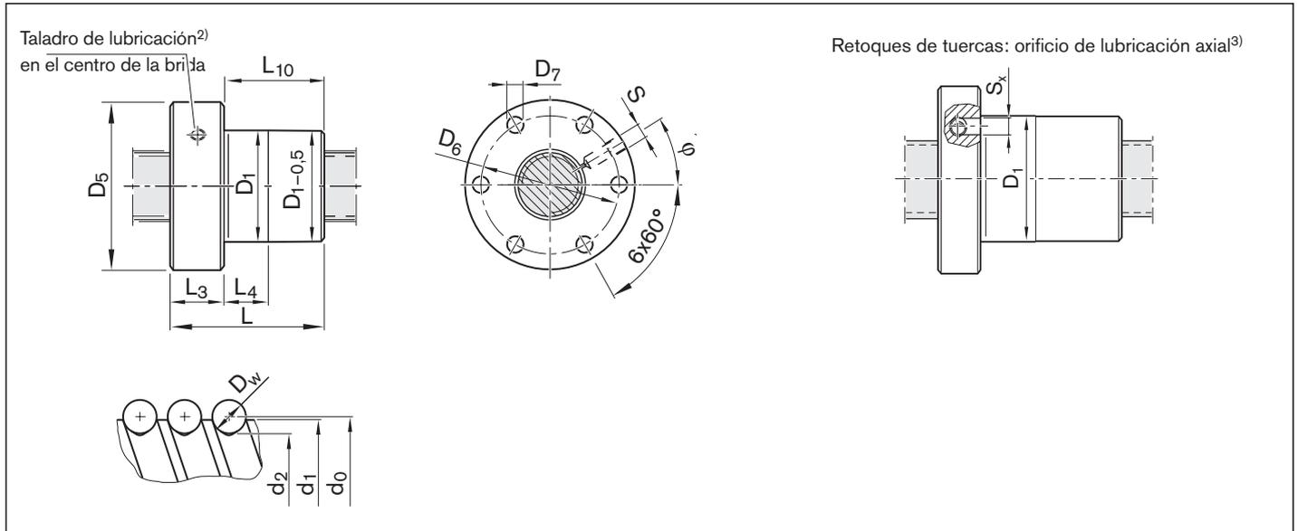
3) El orificio de lubricación axial  $S_x$  está situado siempre en el círculo graduado  $D_6$  de la unidad de tuerca.
