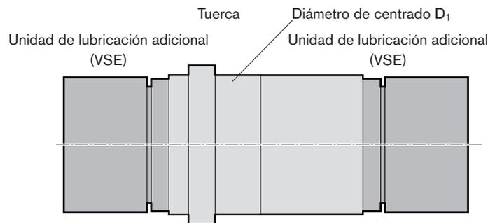
Dirección del montaje de la unidad de lubricación adicional sobre tipos de tuercas
