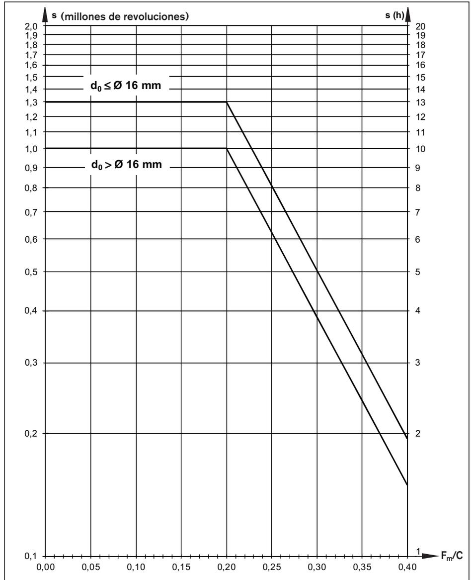
El intervalo de relubricación  $s$  se determina a partir del número de revoluciones en millones o el tiempo de funcionamiento en  $h$ . El valor que se alcance primero determina el intervalo de lubricación.
