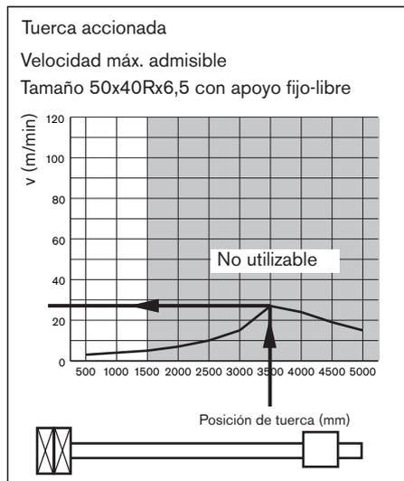
Con la longitud máxima recomendada del husillo L<sub>peso max</sub> en el diagrama de ejemplo en la parte exterior derecha, con una posición de tuerca de 700 mm se alcanza una velocidad de 108 m/min.
